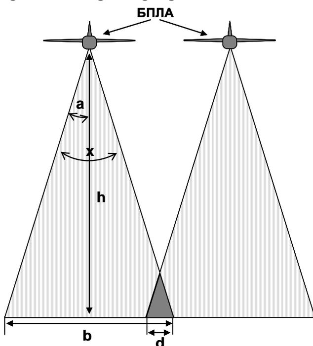
Пример. Заданная высота полета БПЛА  $h=200$  м. Угол зрения фотокамеры  $x = 200$ . Ширина поля зрения камеры на этой высоте  $b \approx 70$  м ( $b$
