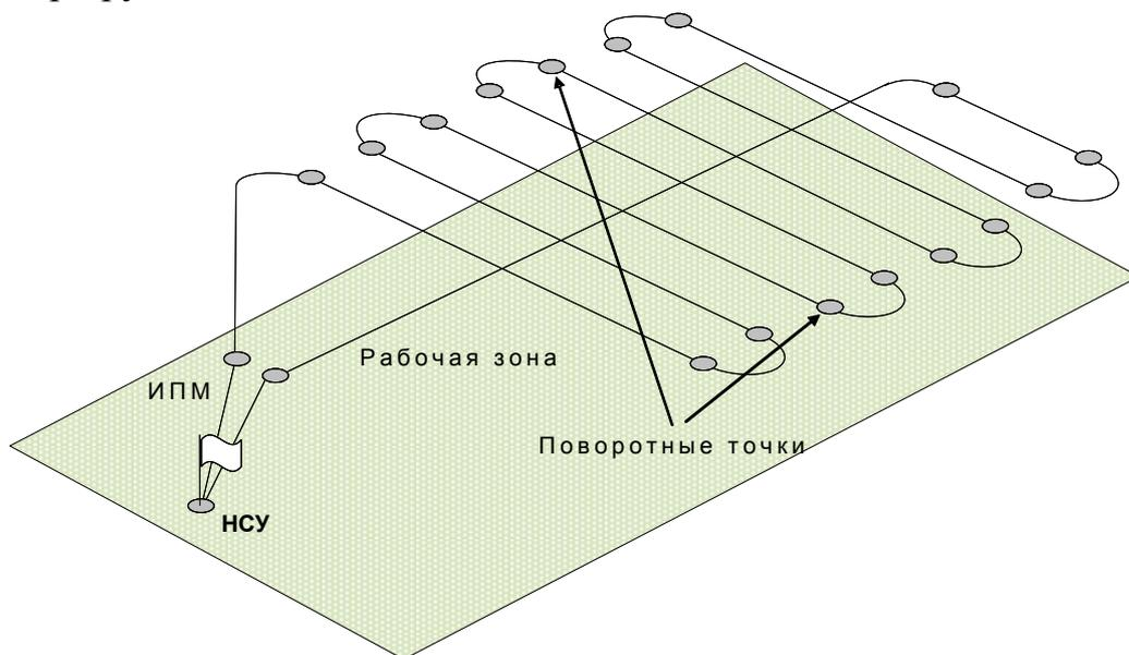
Параллельный маршрут рекомендуется использовать при аэрофотосъемке участков местности. При подготовке маршрута оператор должен учитывать максимальную ширину поля зрения фотокамеры БПЛА на заданной высоте его полета. Маршрут прокладывается так, чтобы края поля зрения камеры перекрывали соседние поля примерно на 15% -20% .
