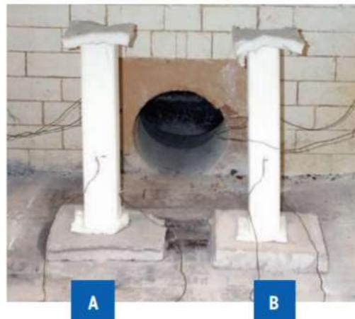
Стальные колонны с нанесенным ТРИОФЛЕЙМ™ АК, до огневых испытаний
