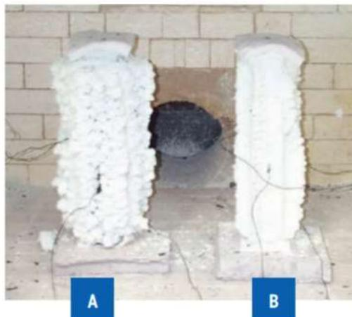
Стальные колонны после огневых испытаний, с образовавшимся пенококсом
