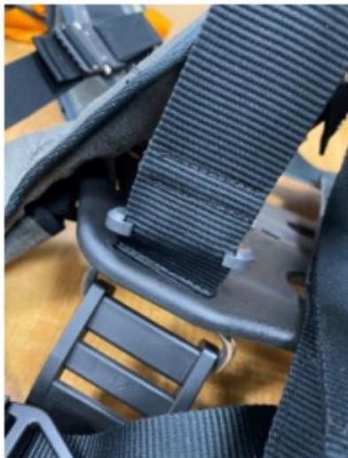
Заменить ремень крепления баллона. Для замены необходимо извлечь пластмассовое крепление. Вытащить ремень из пазов. В обратном порядке установить ремень из комплекта и крепление. Пристегнуть мягкую подушку (для подвесной системы «Комфорт»)
