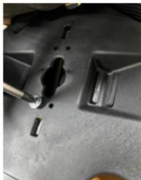
При помощи крестовой отвёртки вкрутить саморезы
