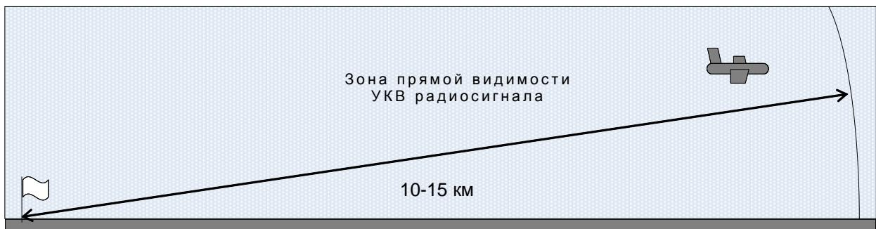
4.3.10 В зоне полета БПЛА могут присутствовать препятствия, которые создают «мертвую зону» для приема УКВ сигнала, это необходимо учитывать при планировании маршрута и высоты полета.
