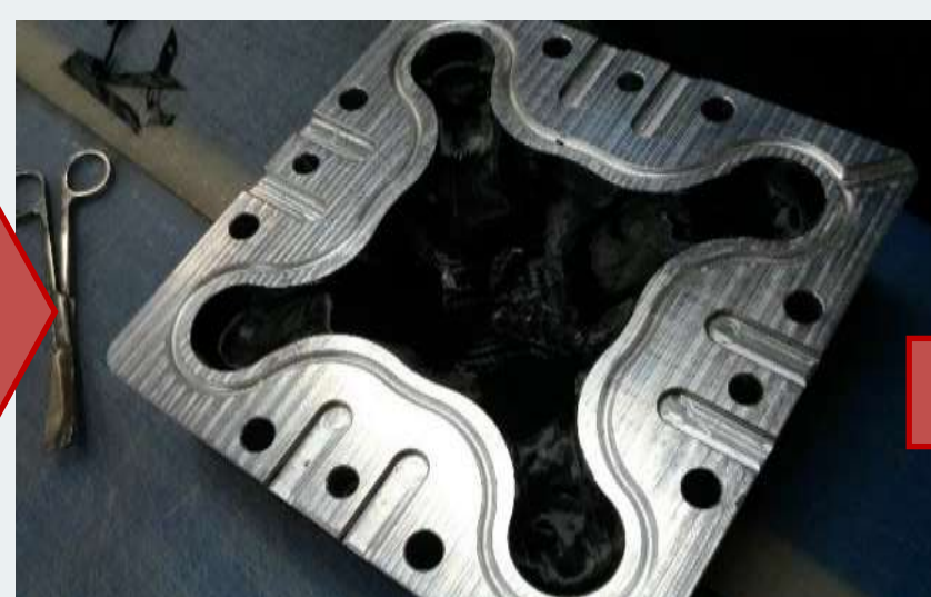
Выкладка препрега в каждую полуматрицу
