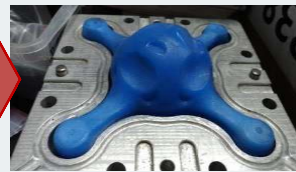
Установка раздувочного мешка и закрытие матрицы
