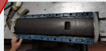
Изделие после мокрой формовки раздувочным мешком
