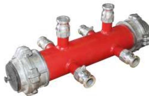
Гребенка разводная ГР-6 для пожарного ствола, предназначенная для разделения потока подаваемой воды при тушении лесоторфяных пожаров. Представляет из себя шестихордовое разветвление для пожарных стволов. Оборудована быстросъемным соединением «Камлок» для подключения рукавов. Условный проход 50 мм. Диаметр выходных отверстий и количество: 20/6.
