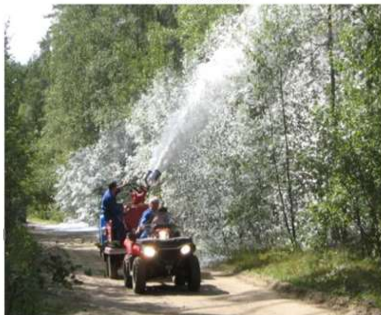
Фото 3. Создание пенной заградительной полосы на ходу ППМ
